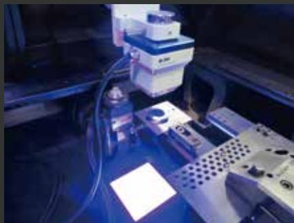
加工後に機上で2μm以内の精度で寸法測定。
